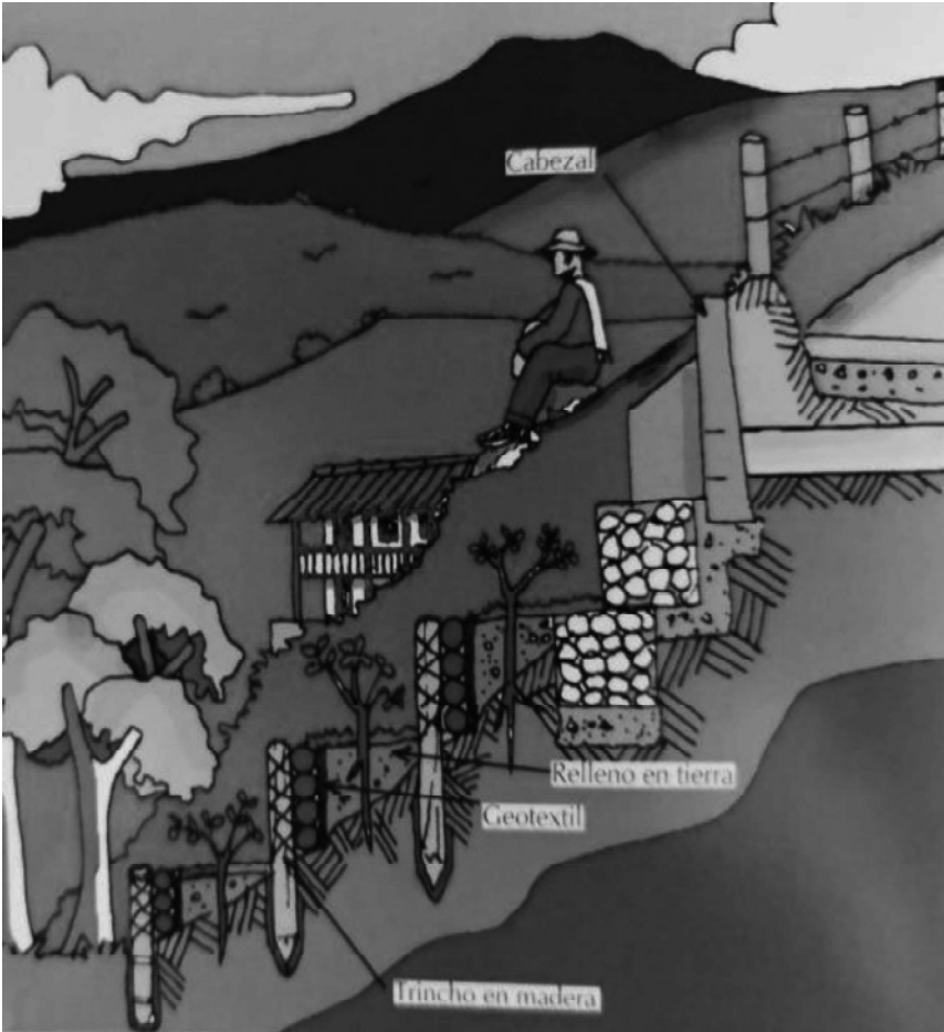
Vista en perfil de dissipadores en trinchos en madera o guadua.
